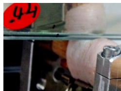
ガラス板の豚の皮への押込み
